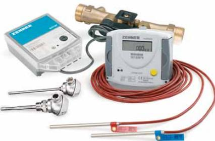
Die Splitt-Ultraschall-Energiezähler bestehen jeweils aus einem statischen Durchflussmesser vom Typ sonar, dem mikroprozessorgesteuerten Rechenwerk multidata WR3 und einem zugehörigen Temperaturfühlerpaar.
